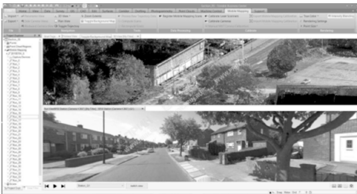
Рис. 3. Панорамный снимок (внизу) и облако точек (вверху) в программе Trimble Business Center
