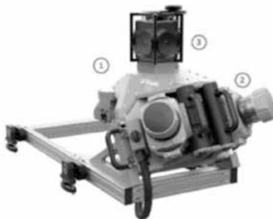
Рис. 1. Система мобильного картографирования Trimble MX9 1 – блок траекторных измерений, включающий спутниковый приемник и инерциальный датчик 2 – лазерный сканер - профайлер 3 – панорамная фотокамера
