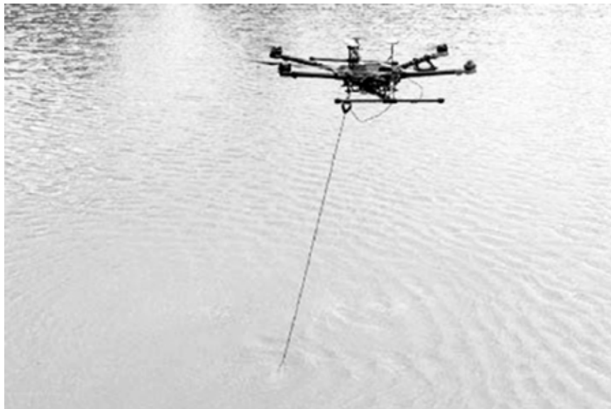
Рис. 4. Дрон с эхолотом
